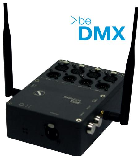
Уникальные гибридные устройства, объединяющие в себе беспроводную передачу DMX512/ArtNet/sACN-поток и работу в сетях Ethernet.
